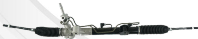
CAIXA DE DIREÇÃO HIDRÁULICA S/PIVO FREEMONT 11/16 / DODGE JOURNEY 09/18
